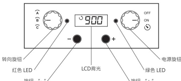
**转动：**按下黑色“+”或“-”按钮，可以增加或减少每天腕表上链旋转的次数。每一档“上”或“下”的变化为50转。单日旋转次数最低设定为300次，最高1200次。LCD显示屏会显示装置当前的设置状态。装置预设为每天900转。
